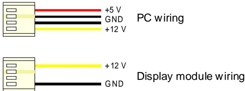
Figure 2-5 Wiring for 12 volt modules
